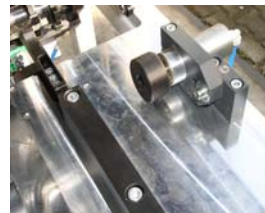
HDF_04: Robuste Motoren, bis zu 6 Frässcheiben auf einer Welle, pneumatische Fixierung der Profile
