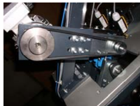
HDF_04: Robuste Motoren, bis zu 6 Frässcheiben auf einer Welle, pneumatische Fixierung der Profile
