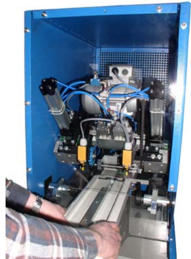
HDF_04: mit 4 Motoren, gleichzeitige Bearbeitung von zwei Profilen
