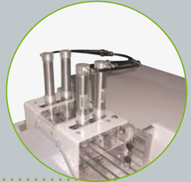
GLS 102 with clamping unit, vertical and standard fixture (incl.) GLS 102 avec unité de serrage vertical et cale standard (y compris).
